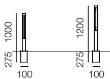
**Structure :** Acier peint | **Support végétal :** Filin inox (HEDERA) | **Fixation :** À sceller, sur platine ou sur fourreau (ORIGAMI), sur platine avec fourreau de réservation (HEDERA)
